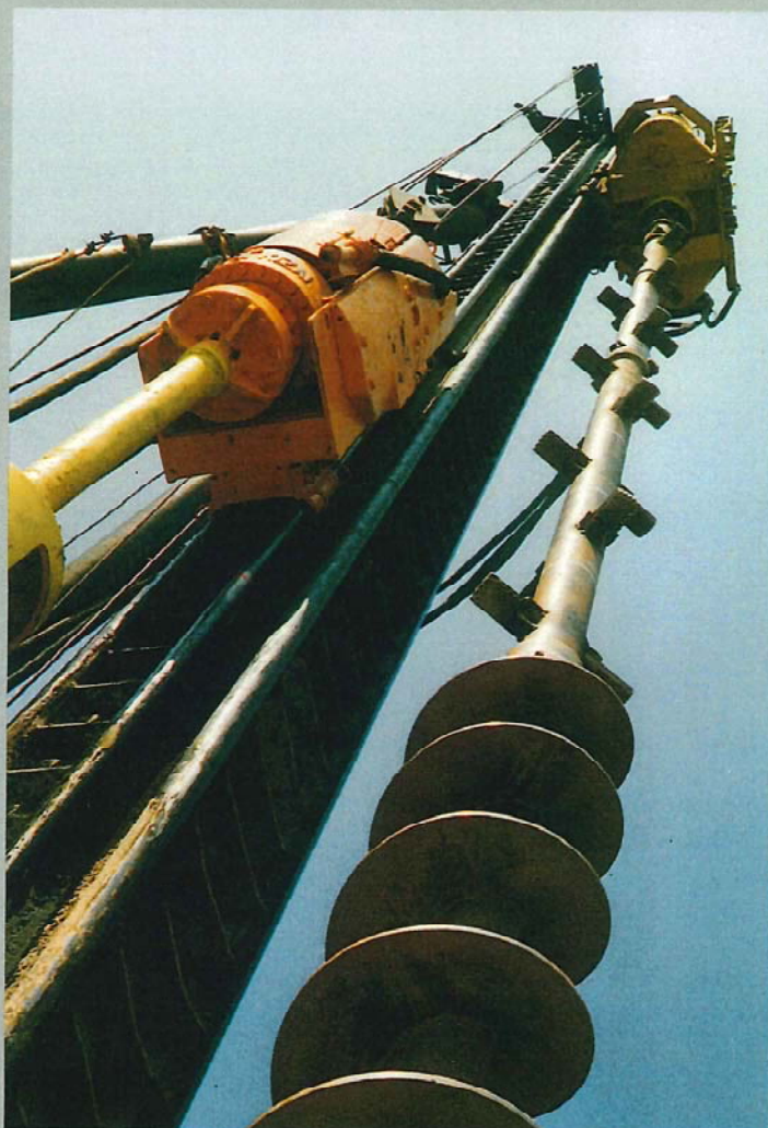
掘削攪拌シャフト
