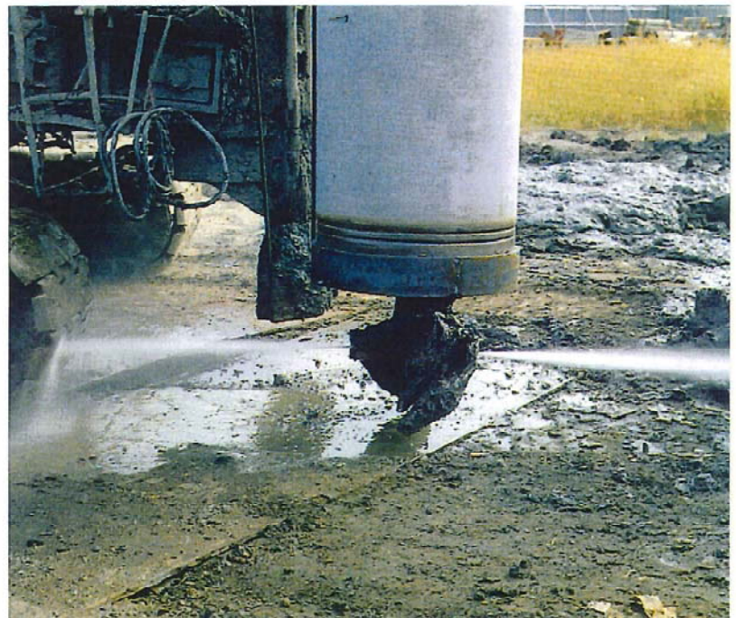
▼STJビット高圧噴射地上試験
